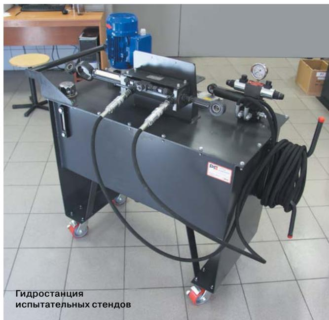
Гидростанция испытательных стендов
