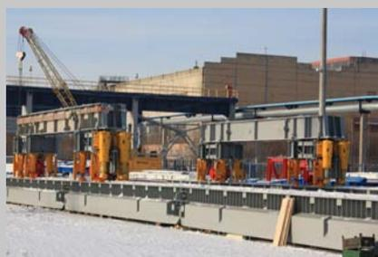
Установка полностью укрыта – от кронблока и до приемного моста, имеет систему комбинированного обогрева. Это позволяет осуществлять ее непрерывную эксплуатацию при практически любых погодных условиях.
