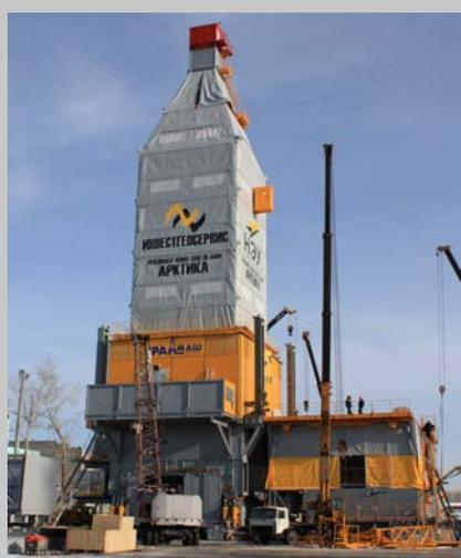
Буровая установка «Арктика» - представитель нового поколения эшелонных буровых комплексов с частотно-регулируемым приводом со сдвоенным эшелонном в контейнерном исполнении. «Арктика» оснащена вышкой башенного типа, верхним приводом, высокопроизводительными буровыми насосами и буровой лебедкой, циркуляционной системой большой емкости с четырехступенчатой системой очистки буровых растворов и многим другим оборудованием, определяющим современный дизайн установок.
