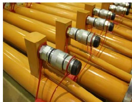
В конструкции гидроцилиндров используются уплотнительные элементы, изготовленные с применением современных композитных материалов, которые обеспечивают стабильную работу и высокую износостойкость элементов в широком диапазоне температур (до  $-50^{\circ}\text{C}$ ) и самых сложных климатических условиях. Еще одной отличительной особенностью гидроцилиндров, изготовленных ЗАО «Гидросила» для буровой установки «Арктика», является большой ход поршня (4900 мм) и общая длина (5500 мм).
