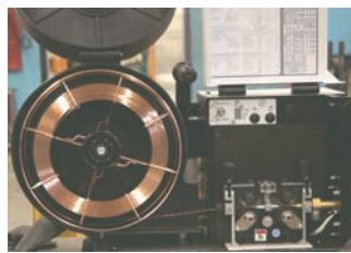
В рамках программы развития и модернизации производства ЗАО «Гидросила» было произведено обновление сварочного оборудования. Введен в эксплуатацию инверторный аппарат для импульсной сварки постоянным током немецкой компании «EWM», с водяным охлаждением и устройством подачи проволоки.
